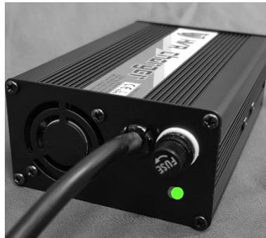
Die Batterie ist vollständig geladen. 60 Sekunden darauf schaltet sich das Motorrad ab und die grünen LED's am Motorrad erlöschen. Am Ladegerät leuchtet die LED grün.
