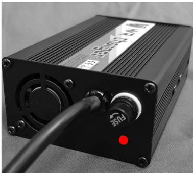
Die Batterie wird geladen, nach und nach leuchten immer mehr grüne LED's (die letzte blinkt) je nach SOC (Ladezustand) siehe Tabelle. Am Ladegerät leuchtet die LED rot.
