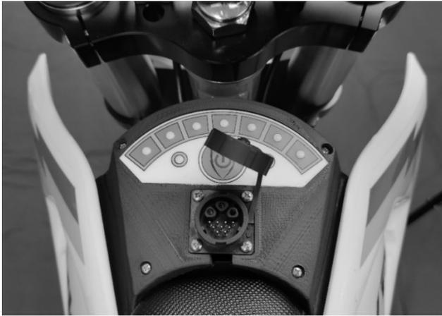
▷ Verbinden Sie den Ladestecker des Ladegerätes mit dem Ladeanschluss des Motorrads (Bajonetverschluss), das Laden beginnt nun automatisch und die LED am HVR Ladegerät leuchtet rot.
